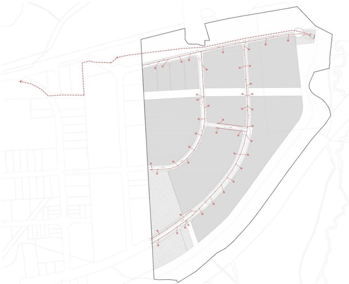
Ilustración 32. Red de saneamiento de aguas fecales propuesta para el Plan Regional y conexión exterior por su extremo noroeste
