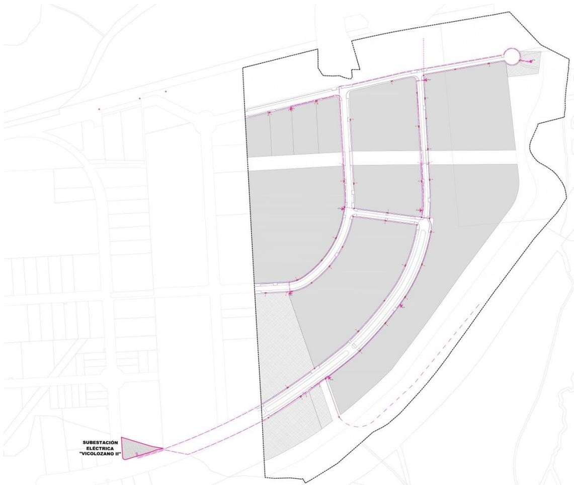
Ilustración 30. Redes de electricidad y telecomunicaciones, y conexión con subestación eléctrica pendiente de ejecución
